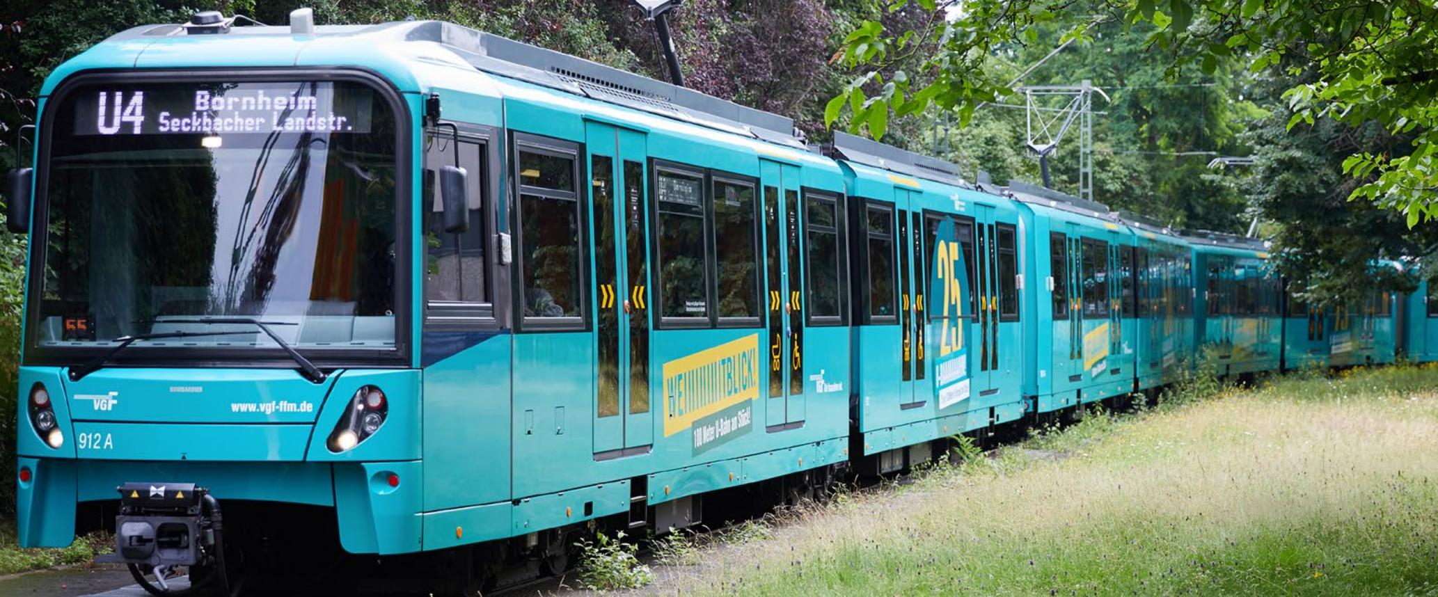
Verlängerung für den U-Bahn-Typ „U5“: Mit den neuen modularen Mittelteilen ist er flexibel auf 75 oder 100 Meter Länge zu erweitern.
