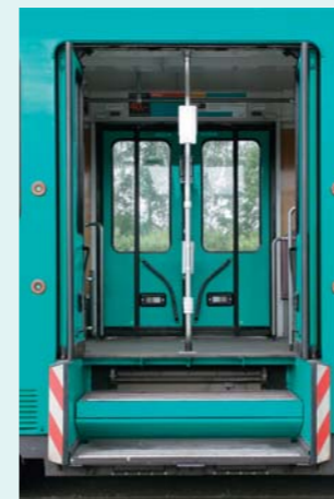
Die Einstiegsbreite der Einzeltüren am Wagenanfang und Wagenende beträgt 62,5 cm. Die Doppeltüren in der Wagenmitte sind durch eine Mittelstange geteilt und jeweils 59 cm breit.
