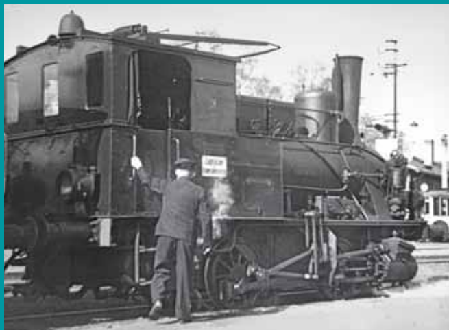
Die 1900 bei der Firma Hagans in Erfurt gebaute Dampflokomotiv 2 der FLAG mit dem Namen „Hohemark“ steht im Jahr 1955 in Heddernheim in Fahrtrichtung Oberursel. Sie war mit einem Lyrabügel für das Betätigen von Fahrleitungskontakten (u. a. für die Signalschaltung) ausgestattet und zudem auch für den Betrieb auf Bundesbahngleisen zugelassen. Foto Walter Steinberger Archiv VDVA
